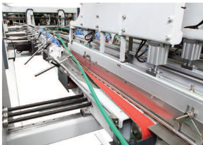
FOT. 3. GÓRNE PASY ZAMYKAJĄCE Z NIEZALEŻNYM SERWOMOTOROWYM SYSTEMEM NAPĘDU W MASZYNIE MEGAFOLD-1450SL
