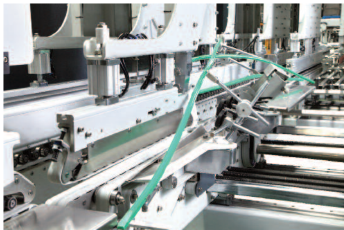
FOT. 2. SYSTEM NAPĘDU GÓRNYCH PASÓW PROWADZĄCYCH W MASZYNIE MEGAFOLD-1850SL
