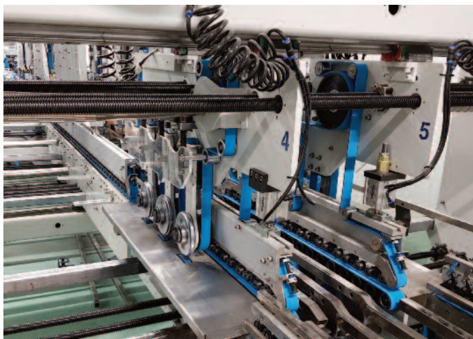
FOT. 1. NA ZDJĘCIU MODUŁ BIGUJĄCY W MASZYNIE MEGAFOLD-1450SL
